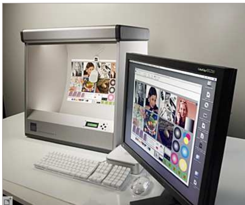
Poste de travail pour comparaison écran-papier avec une boîte à lumière Color Communicator2 (Just Normlicht).
