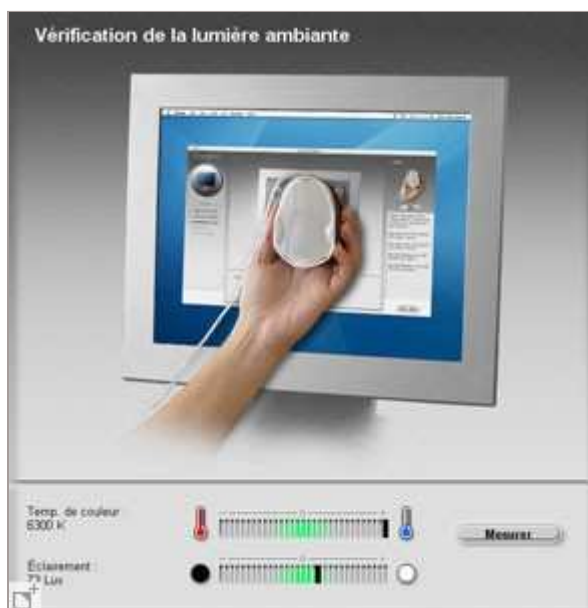
Mesure de la lumière ambiante au niveau de l'écran avec un colorimètre Eye-One Display2 muni de son diffuseur translucide.
